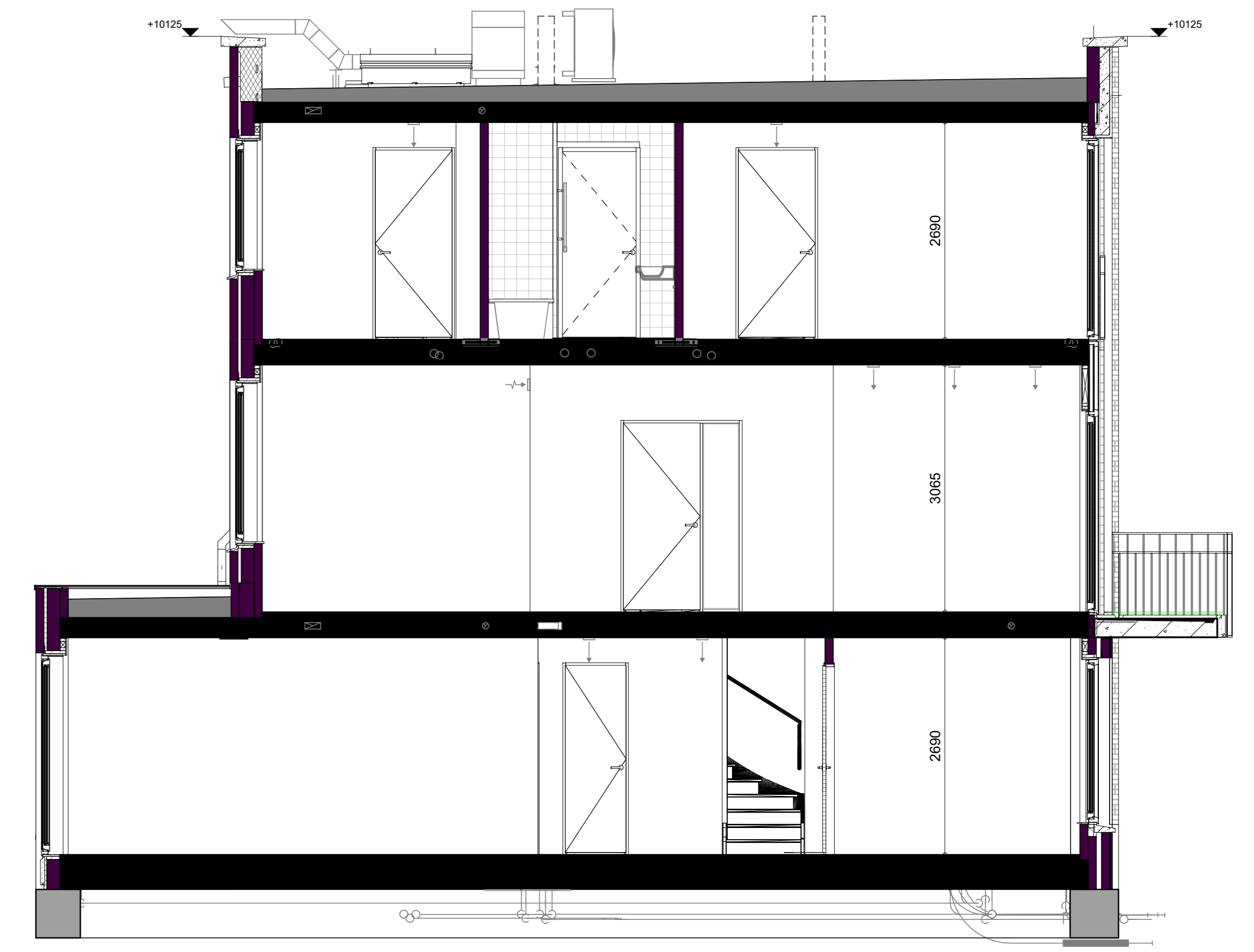
Doorsnede - uitbouw 2,4m
