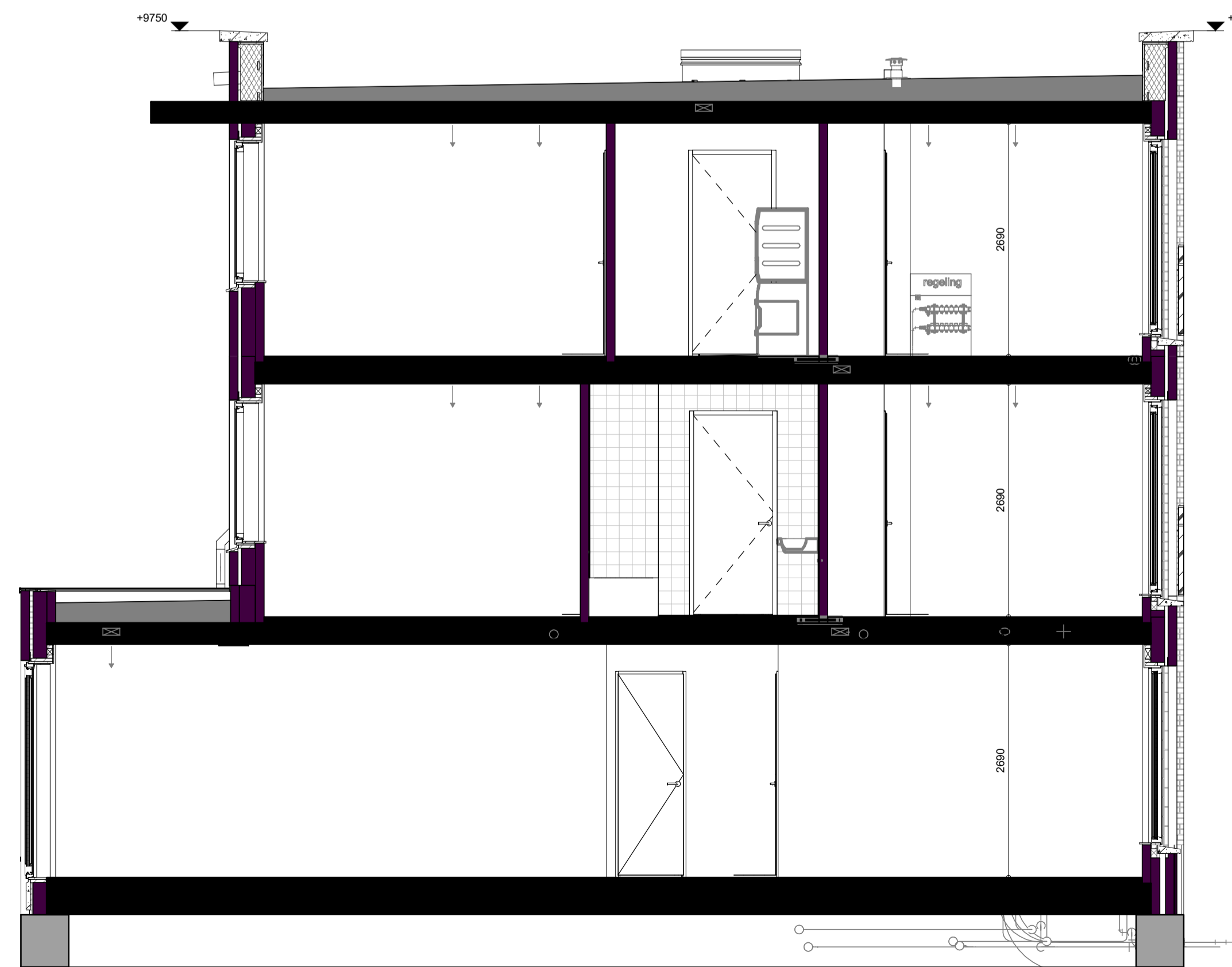
Doorsnede - uitbouw 2,4m
